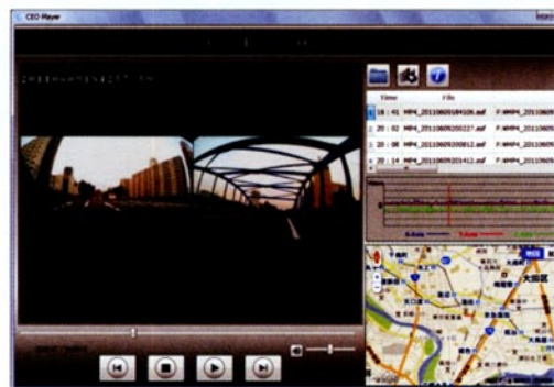
再生画像は、2個のカメラ映像に加え、音声、Gセンサーによる振動情報、GPSから算出した速度情報と地図情報などがすべてリンクされる。付属の再生ソフトは、ウインドウズマシンに対応する。
