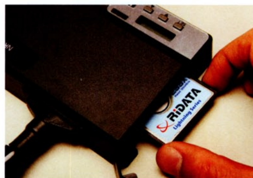
記録媒体はCFカードで、本体購入時に8GB仕様が付属。これ1枚で連続7時間の録画ができる。メインユニットは、120×85×26mmの寸法。さまざまなBMWモデルのシート下に搭載可能だ。
