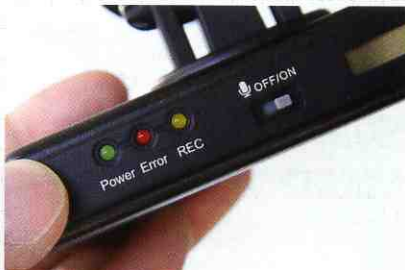
↑電源のON/OFFの確認から各種警告は信号機と同じ3色のLEDで表示してくれる。音声録音のON/OFFも選択が可能
