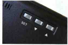
↑本体の3つのボタンによって、フォーマットや日付けや時刻設定を行う。時刻は小型の液晶パネルに表示される
